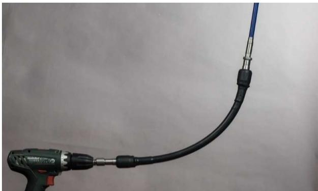
**ART. 910.PR.05.G** - Innovativa sonda realizzata con albero rotante protetto da guaina esterna che permette:
